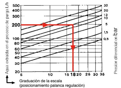
Por medio de la escala graduada, la palanca permite el ajuste exacto de la tobera dosificadora. Colocaremos la palanca en la posición que nos permite evacuar un caudal de agua (P) a una presión diferencial. Presión diferencial = Presión de trabajo - (Contrapresión + Pérdidas de carga). La purga continua se consigue con valores de ajuste del 0 al 35.
